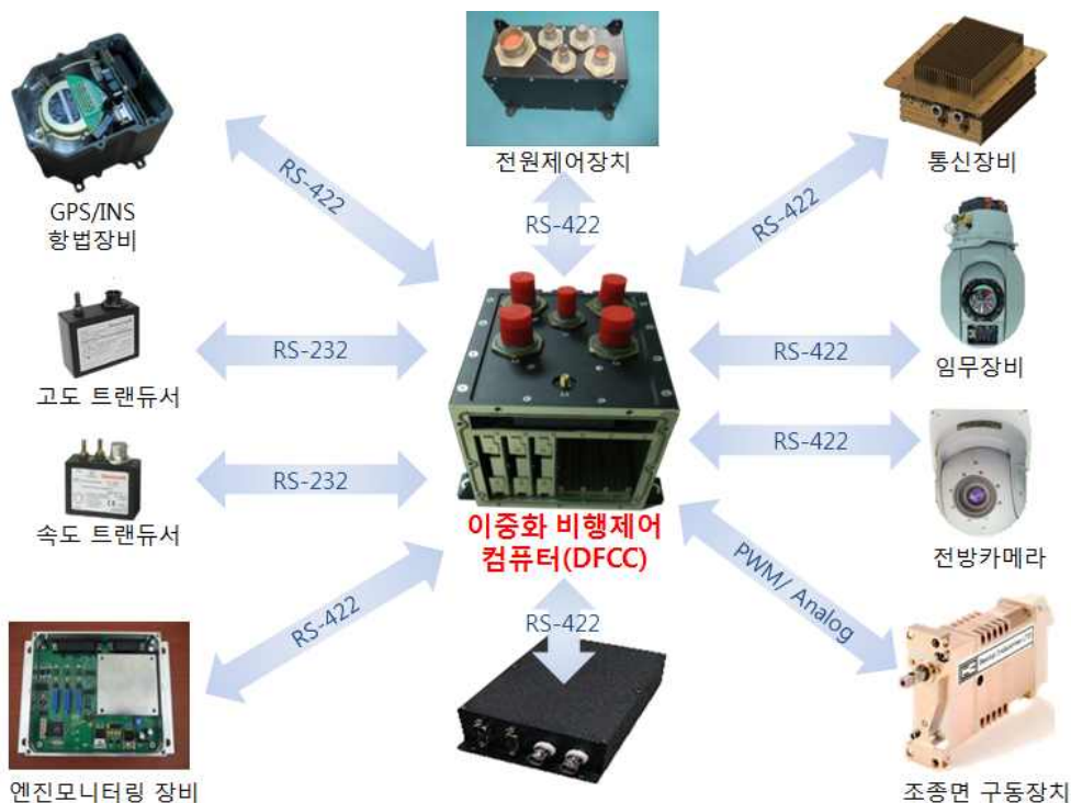
<그림 3> KUS-9 탑재시스템 구성
