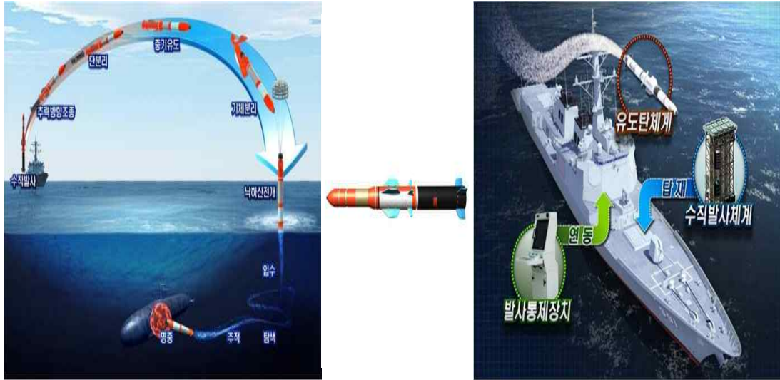
<그림-4> 홍상어 무기체계의 원리, 장입유도탄, 체계 구성 15)
