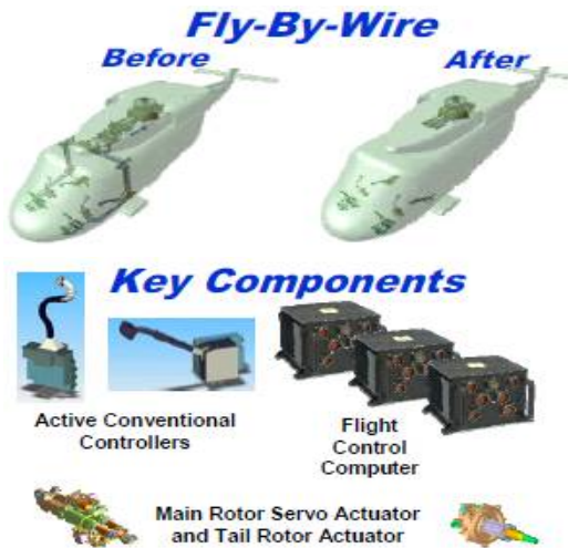
그림 11. UH-60M 디지털 비행제어시스템 개량 사업의 주요 변경 사항[21]
