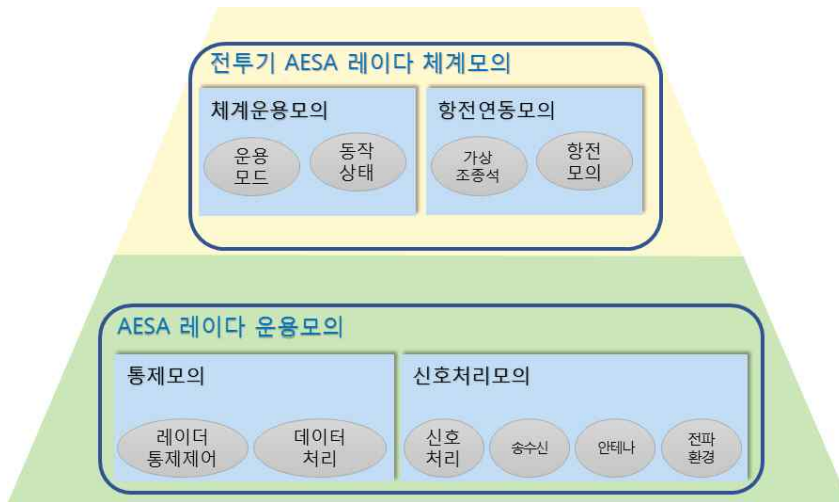
<그림 3> 전투기 AESA 레이더의 체계모의 환경 구성
