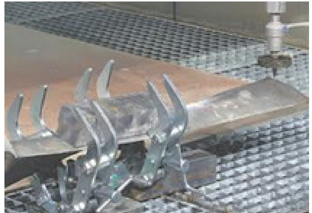
<그림 7> Reconditioning Turbine Blades
