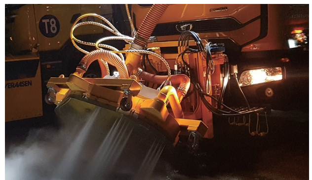
<그림 8> Rubber Removing Equipment in Runway
