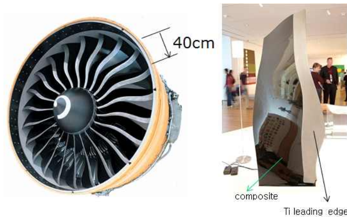
<그림 8> B787용 엔진 GE90의 복합재료 팬 블레이드
