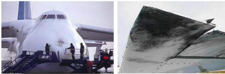
(a) 레이돔 부근 낙뢰가격 (b) 복합재료 조종면의 낙뢰가격
